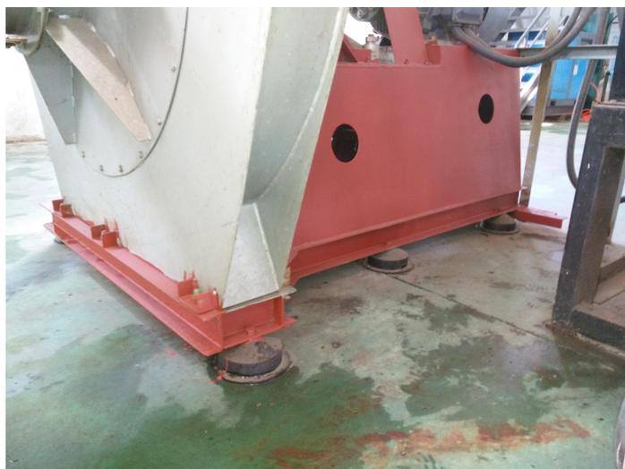
图 3-5 设备加装减震垫
